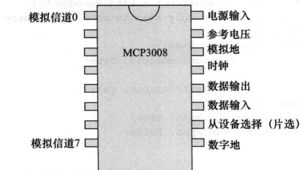
图 11-10 自上至下，芯片的左边 8 个接口分别表示 0~7 的模拟输入，右边 8 个接口用于芯片控制。在塑料封装的上面有一个半圆形缺口，表示芯片上端，在对照图片时需要对准该缺口
