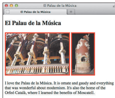
图 8.2.3 将这个样式规则（4 像素宽的红色实线边框）应用于每个 img 元素
