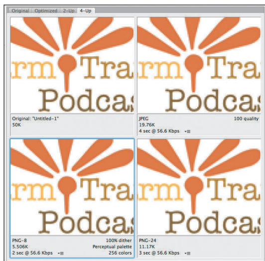
图 5.4.5 这个图像（已被放大）有很多平铺的颜色及文字，它们需要保持锐利。可以看到，PNG-8 格式（左下）对图像的压缩是最好的，文件大小只有 5.5K。如果减少颜色的数量，其大小还将进一步减小。PNG-24 可以提供更多的颜色，使用这种格式的话，文件大小为 11.17K。使用最高质量的 JPEG 则为 19.76K。如果将 JPEG 的质量降为 50（这里没有显示），文件大小可比 PNG-8 更小一点，但其效果看上去却很可怕。另见彩插
