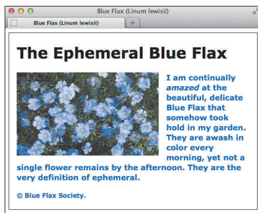
图 7.3.4 这里展示了继承的实际效果（以及未继承的效果）。h1 从 body 中继承了 Verdana 字体样式（由 font-family 设置）。它在图 7.3.3 中没有自己的样式，因此它还会根据浏览器的默认样式进行显示，即显示为黑色粗体的标题样式。类似地，em 和 small 元素也没有指定具体的样式规则，但它们也从 body 继承了 Verdana 字体样式，从 p 继承了 font-weight 和 color 的样式。用 small 标记的文字（法律声明）比周围的文字小一些，这也是浏览器的默认样式。最后，包含所有内容的 div 有一个细线边框和内边距，但其中的其他元素没有这样的样式，因此这些属性不会被继承
